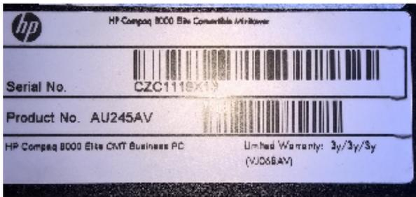
Rechner des Herstellers HP tragen diesen Aufkleber auf der Oberseite in der Nähe der Rechnerfront. Die "Product No." ist nicht die Seriennummer, sondern nur die genaue Modellbezeichnung des Rechners. Wir benötigen die "Serial No.", die unter dem Strichcode steht um den Rechner eindeutig identifizieren zu können.
