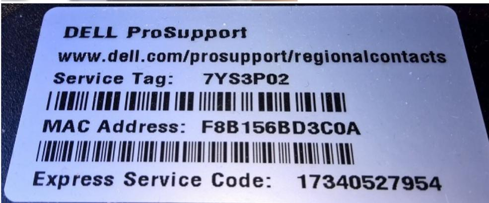
Der Service-Tag befindet sich bei Dell-Laptops auf der Unterseite, auf einem, wie im obigen Bild gezeigten, Aufkleber. Bei großen Rechnern befindet sich das Service Tag vorn auf dem Deckel (s. Bild) und bei kleineren Rechner auf dem linken Seitenteil. Der Dell ServiceTag ist dann interessant, wenn es um technische Angelegenheiten mit Dell Rechnern geht(Garantiefragen, Hardwaredefekte, Installation neuer Treiber).
