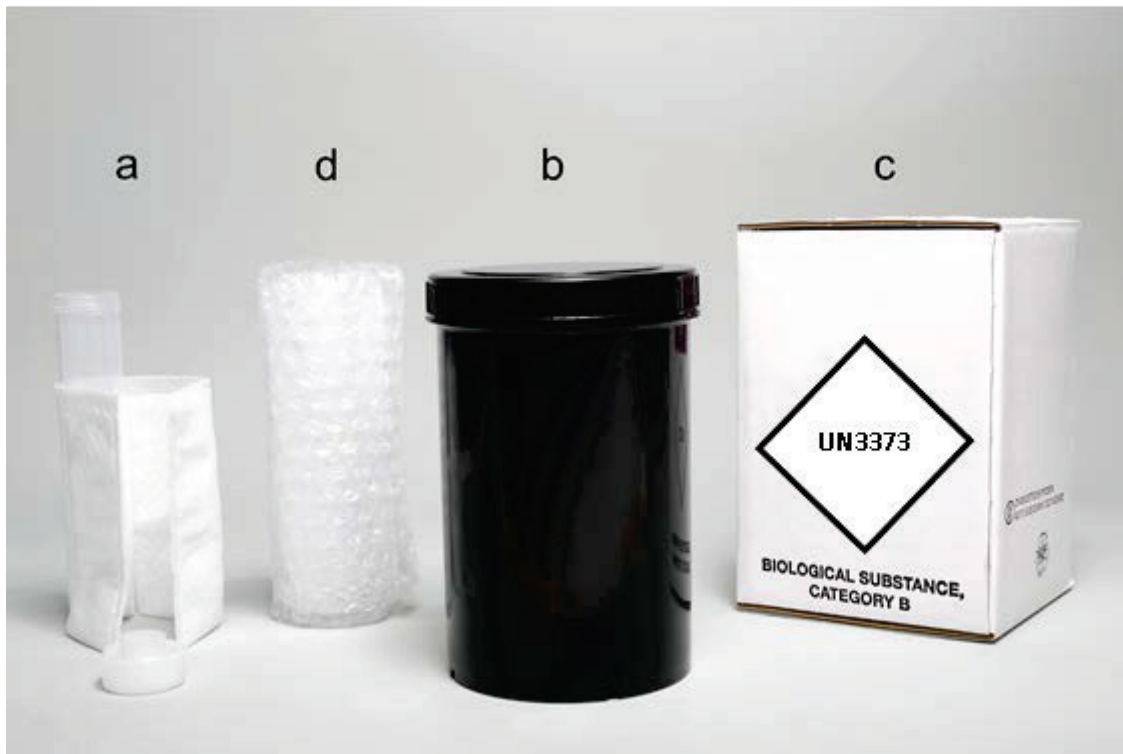
Abbildung 1: Verpackung für biologische Stoffe, Kategorie B (UN3373): a) Primärbehälter mit absorbierendem Material; b) Sekundärverpackung; c) starre Außenverpackung; d) Polstermaterial.
