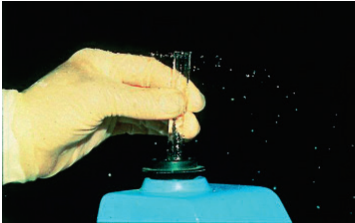
Abbildung 5: Aerosolbildung am Vortexmischer
