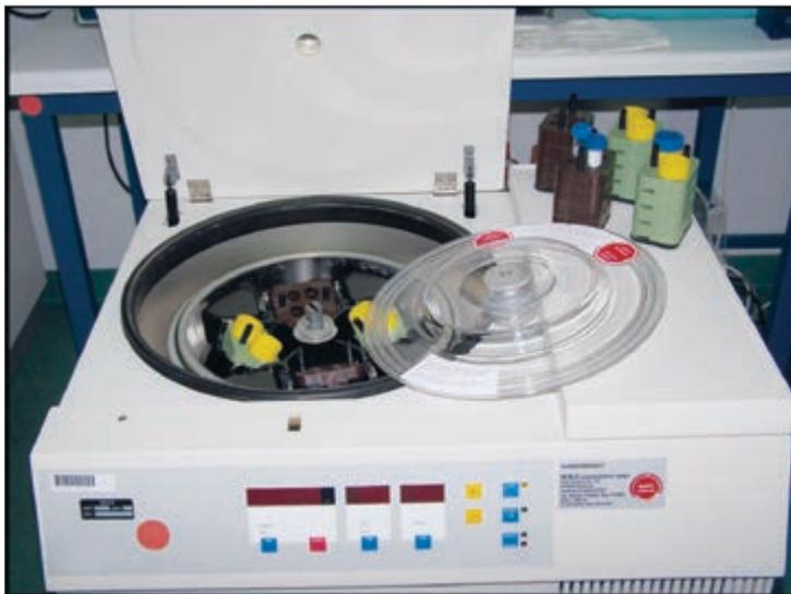
Abbildung 7: Universelle Tischzentrifuge mit Rotor, Adapter und Rotordeckel
