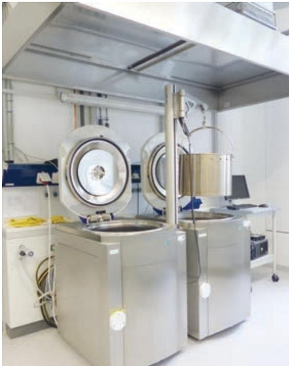
Abbildung 15: Vertikale Standautoklaven
