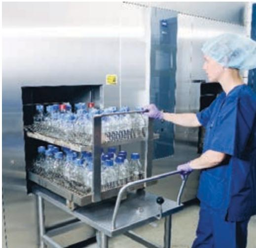
Abbildung 18: Vorbereitung zur Dampfsterilisation von Flüssigkeiten in ISO Flaschen
