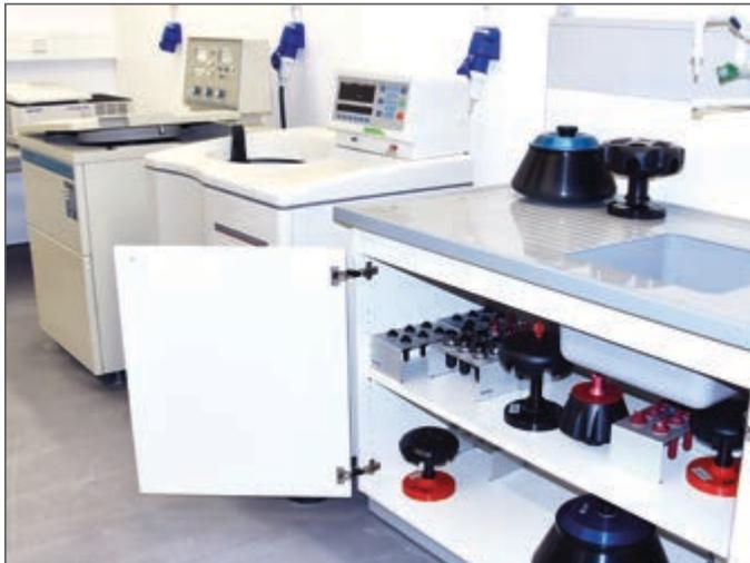
Abbildung 8: Lagerung von Rotoren und Zubehör; im Hintergrund: zwei Ultrazentrifugen
