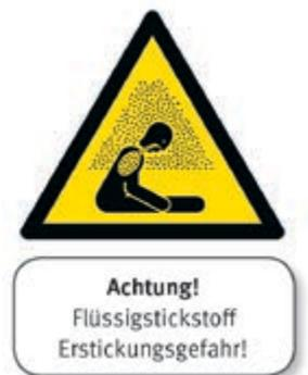
Abbildung 20: Kennzeichnung am Zugang zu Einrichtungen mit Erstickungsgefahren nach ASR A1.3
