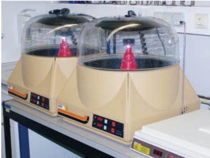
Abbildung 25: Aerosoldichter Schüttelkultur-Inkubator
