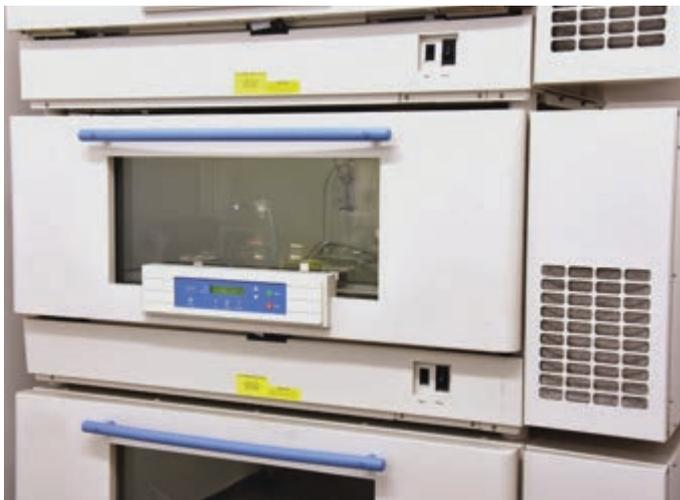
Abbildung 26: Inkubierte stapelbare Schüttler
