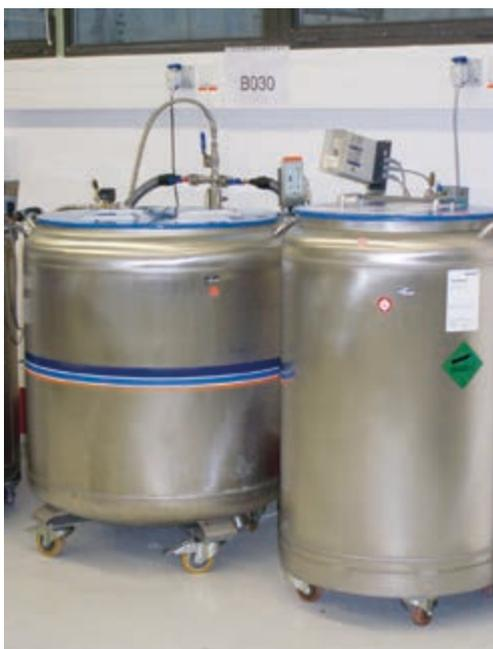
Abbildung 22: Flüssigstickstoff-Lagerbehälter mit Auffüllautomatik
