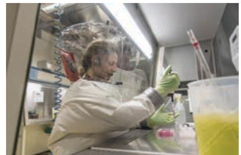
Abbildung 49: Tätigkeit an einer MSW im fremdbelüfteten Vollschutzanzug
