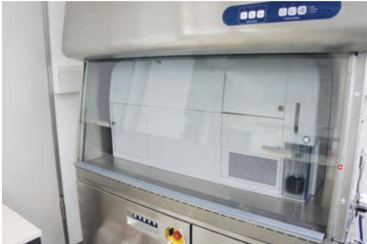
Abbildung 11: FACS-Gerät innerhalb einer MSW
