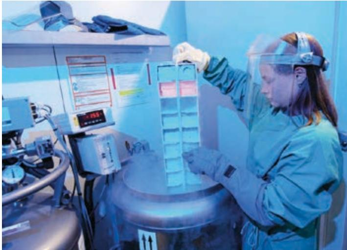
Abbildung 21: Tätigkeiten am Flüssigstickstoffbehälter mit typischer Schutzkleidung
