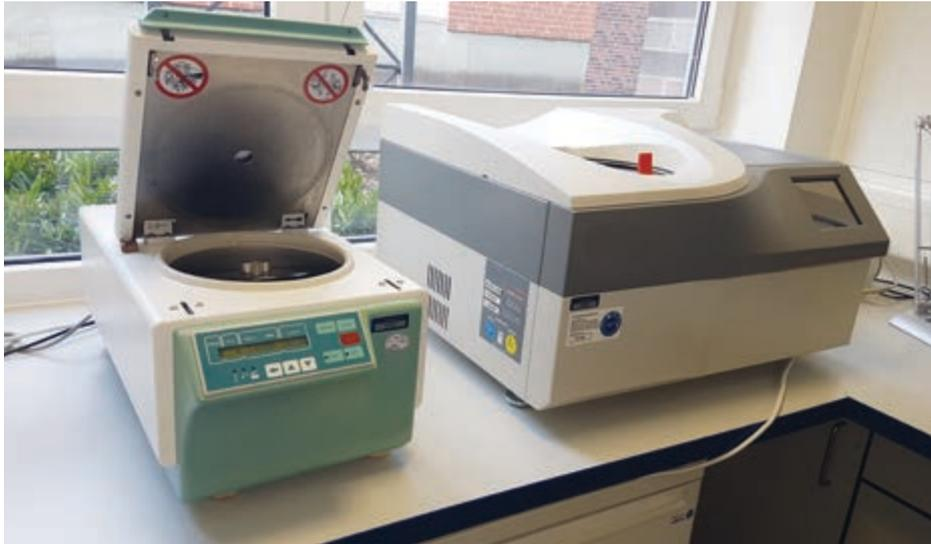
Abbildung 6: Beispiele für Tischzentrifugen
