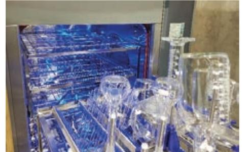
Abbildung 52: Laborspülautomat zur Reinigung und Desinfektion
