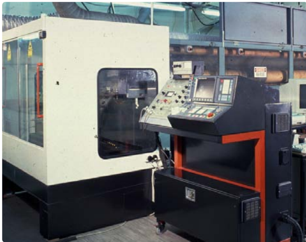
Sichtpaneele im abgeschirmten Bereich
