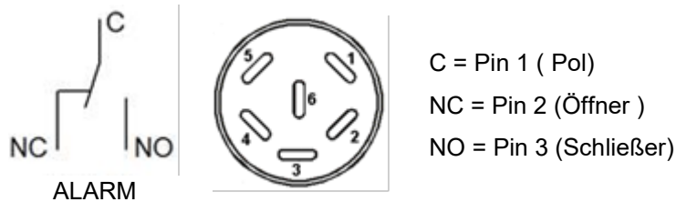
Abb. 15: Schaltbild der potenzialfreien Kontakte und Pinbelegung der DIN-Buchse (13)
