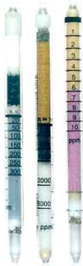
Abb. 17: Beispiel für chemische Messindikatoren
