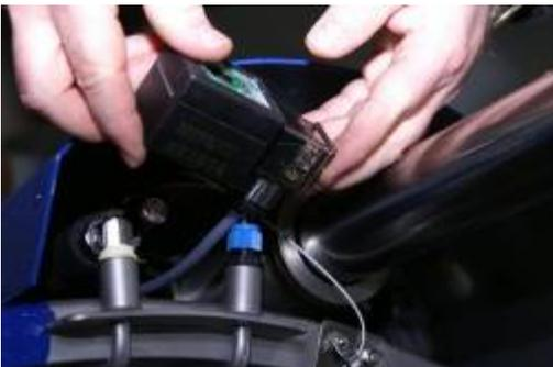
Kabel unter die Abdeckung führen, Magnetspule wieder aufstecken und mit Sicherungsblech befestigen.
