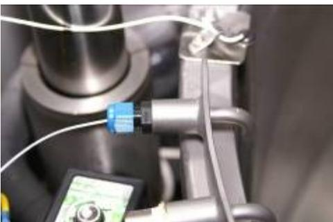
Ist die Temperatur – Sonde in der richtigen Position, muß die Verschraubung dicht verschraubt werden.
