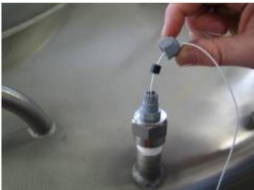
Reduziermuffe auf Anschlussstutzen aufschrauben,
