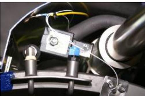
Kabel der Füllstands – Sonde und der Temperatur – Sonde mit Kabelbinder fixieren.
