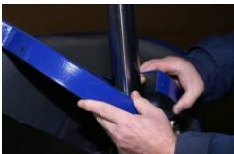
Armaturenabdeckung am Öffnungsschnitt auseinander ziehen und über die Welle des Hebemechanismus ziehen.
