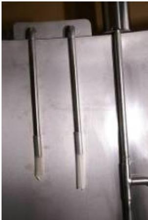
Temperatur – Sonde soweit in die Messleitung einschieben, bis die Spitze gerade aus dem Schutzrohr heraus kommt.
