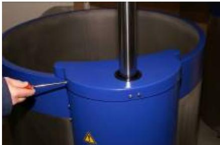
Die 4 Befestigungsschrauben der Armaturen - Abdeckung am CHRONOS® lösen
