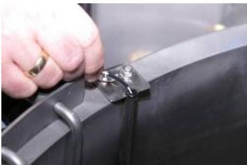
Runde Durchführungstülle in das Spritzschutzrohr schieben und danach den Kabelschuttschlauch in diese runde Durchführungstülle schieben.
