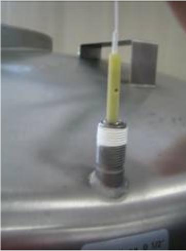
Gewinde des Anschlussstutzens mit PTFE-Dichtband eindichten.
