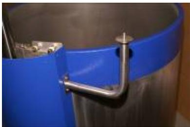
Halterung für BIOSAFE-CONTROL® β am CHRONOS® - Behälter wie gezeigt anschrauben.
