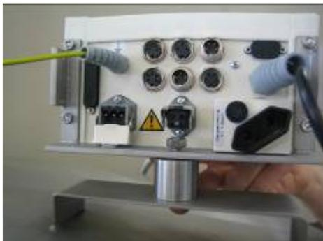
Mit Federring und Mutter (M8) handfest anschrauben.
