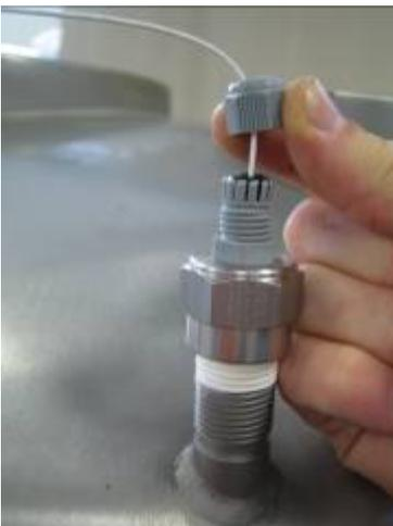
Dichtgummi in die Kabelverschraubung einführen und Kabelverschraubung verschrauben
