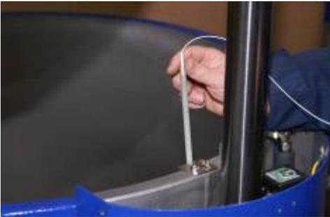
Füllstands \_ Sonde in das dafür vorgesehene Spritzschutz – Rohr einführen.
