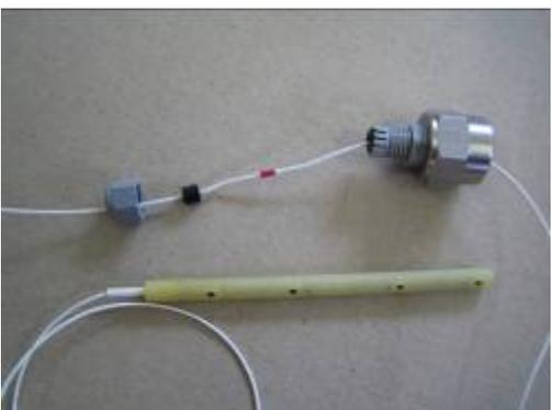
Kabelverschraubung (PG7) und Reduziermuffe (1/2" – 1/4") auf das Sondenkabel aufziehen.
