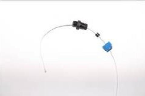
Die Temperatur – Sonde wie gezeigt in die PG7 - Verschraubung montieren
