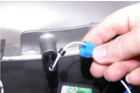
Temperatur – Sonde in die dafür vorgesehene Meßleitung einführen und Verschraubung einschrauben.
