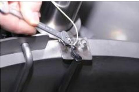
Die vorher eingestellte Befestigungs – Tülle unter die Lasche klemmen und Füllstands – Sonde damit gegen Verschieben sichern.
